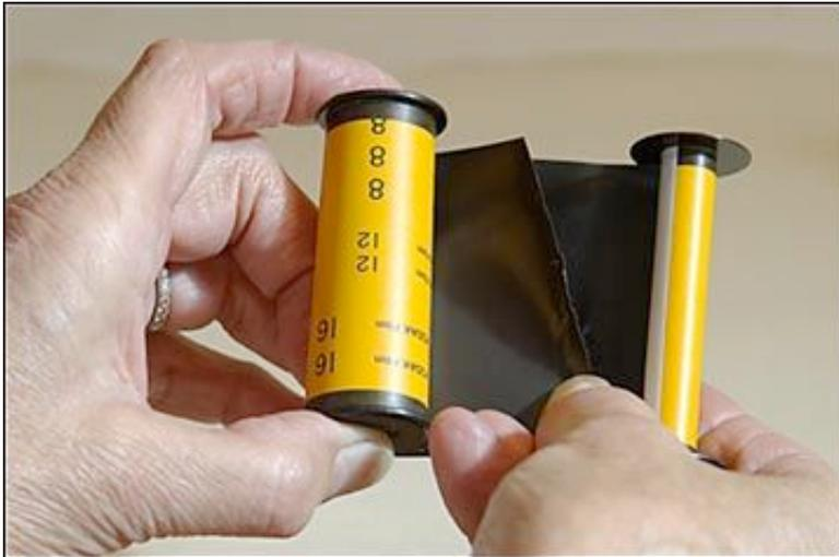
Si le premier transfert est aisé, la bande d'adhésif entraînant normalement le film, au second transfert sur la bobine 620 il faut veiller à ce que la fin du film – qui dans ce mouvement est devenue le début - se place correctement entre le papier et le noyau.
