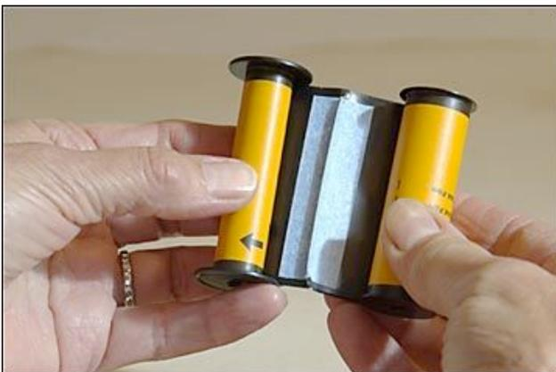
*Le réembobinage sur le noyau 620 est terminé, prêt pour être utilisé dans un appareil de collection.*
