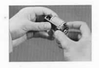
Remettre le cylindre intérieur dans le cylindre extérieur, l'extrémité du film dépassant.
