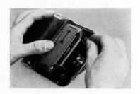
Enrouler le papier sur la bobine vide jusqu'à ce que, celle-ci étant placée dans le logement droit 4, le trait précédant une flèche se trouve entre les dents du tambour d'entraînement 5.
