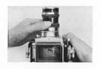
Avec les objectifs de focales plus longues que 5 cm, il faut procéder à la mise au point en faisant tourner l'objectif lui-même et non pas en agissant sur le levier de mise au point, car celui-ci pourrait ne pas supporter sans risque l'effort imposé par une transmission trop élevée.
