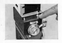
Le déclenchement s'effectue par pression sur le bouton 22. Le dispositif de retardement peut actionner toutes les vitesses de l'obturateur. Si l'on le place en B, il donne une vitesse d'obturation de 1 sec. env. Le dispositif de retardement étant armé, on peut cependant actionner directement le levier de déclenchement 7 et armer ensuite de nouveau l'obturateur.
