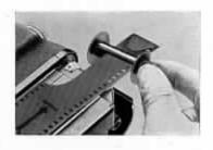
6. Introduire l'extrémité du papier inactinique dans la fente de la bobine vide et la replier à angle vif (casser) à 2 cm. environ du bord, de sorte que le côté noir du papier soit tourné vers l'extérieur.
