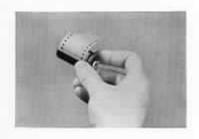
Pour fixer le film sur le noyau, le replier légèrement (émulsion vers l'intérieur) et l'enfiler dans la grande fente de la bobine débitrice.
