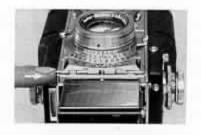
En appuyant sur le bouton 28 le volet du posomètre se soulève et découvre la fenêtre à prismes 25.
