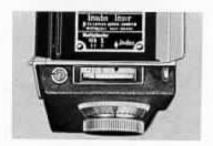
6. Lorsque la lumière est très faible, l'aiguille ne peut être amenée sur le repère . même en abaissant complètement le levier 29. Le temps de pose lu dans cette position du levier doit être multiplié par un coefficient indiqué par la position de l'aiguille qui se trouve alors entre le zéro de l'instrument à l'extrémité de l'échelle et le repère .
